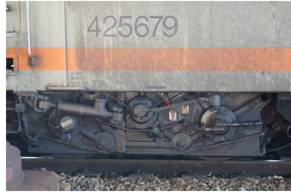
b) Detailansicht des Drehgestells
